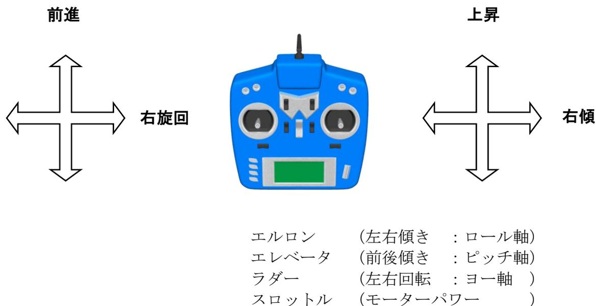
図 - 3 プロポのスティック操作 モード1
